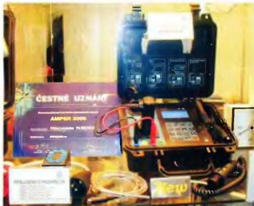
Obr. 4. Oceněný přenosný přístroj PU294 je určený k revizím nejen obvyklých elektrických spotřebičů, ale též zdravotnických elektrických zařízení podle norem ČSN 331600, 331610 a EN60601-1. Vyznačuje se velkou přesností měřených hodnot v širokém rozsahu, oboustrannou možností komunikace s PC, paměti pro 10 000 naměřených hodnot, grafickým LCD displejem s podsvícením a má vestavěny i hodiny. Doplněk PD294 rozšiřuje jeho použití i na oblast třířizových spotřebičů. Rozměry jsou 270 x 240 x 130 mm, hmotnost 4 kg. Další doplňky umožňují jednak ověřeni správné funkce, snímání čárového kódu, měření otáček, teploty, proudů do 20 A klešťovým ampérmetrem a speciální přípravek pro revize zdravotnických přístrojů z hlediska tzv. unikajících proudů
