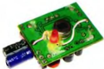
Obr. 5. Úprava modulu PIR
